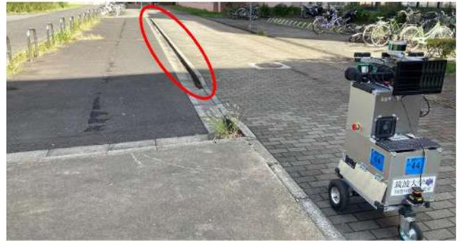
Fig. 8: 実験環境 (赤い丸で囲った部分が約 6cm の段差)
