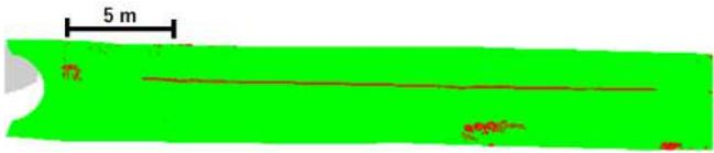
Fig. 11: 作成した段差地図から、「差分値が 5cm 以上を段差」とした段差検出の結果（赤：段差，緑：走行可能領域）
