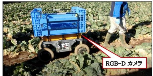
Fig. 1 農業ロボットの収穫支援の様子
