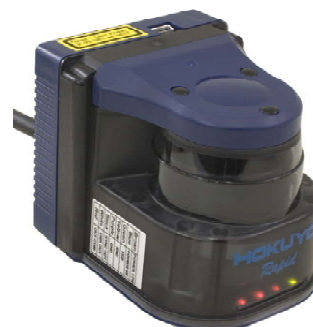
Fig.4 SOKUIKI sensor "Rapid-URG"
