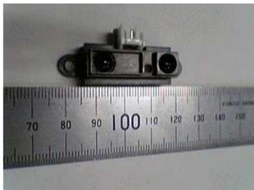
Fig.4 PSD センサ (SHARP 製 GP2D12) の概観
