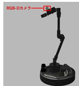
Fig. 1 使用するロボットのハードウェア構成
