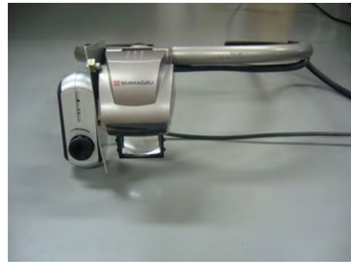
Fig.3 カメラを設置した HMD
