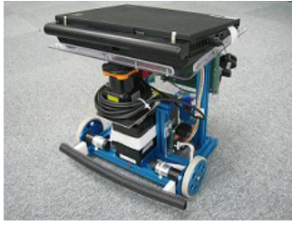
Fig. 2 センサ「URG(UTM-30LX)」を搭載した自律移動ロボット「beego」
