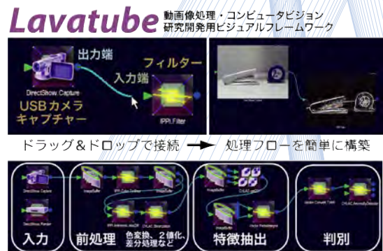
さまざまな画像処理をGUI上のアイコン接続で構築可能 図2. Lavatube(オープンソースとしてWEBで公開中)
