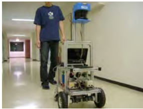
図1. 屋内外を自律走行するキャンパスガイドロボット
