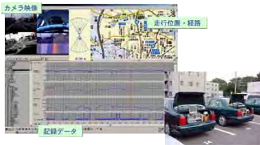
運転行動計測用車両と計測された運転行動データの一例
