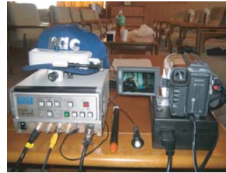
図 3 実験装置：ナックイメージテクノロジー株式会社のアイ・トラッカー EMR-8B ( Eye Make Recorder 眼球運動計測装置) [1]。検出レート：60HZ(片目) 検出分解能：眼球運動、瞳孔径 0.02mm ヘッドユニット重量：約 250g
